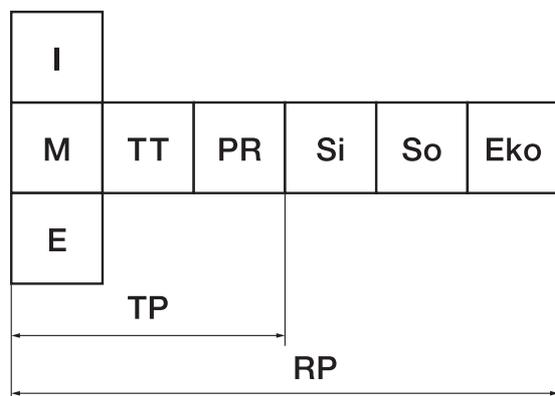
Tehnološki proces (TP) čine tehnički materijalni elementi, a uključivanjem čovjeka nastaje radni proces (RP) s dodatnim naznačenim elementima. Izvođenje radnoga procesa započinje informacijom o radnoj zadaći (I), prema kojoj se odabiru materijal (M) energija (E) i tehnička sredstva (TT) za preradbu materijala prema pravilima rada (PR) u prikladne proizvode. Pritom treba voditi računa o sigurnosti i zaštiti na radu (Si), socijalno-ekonomskim odnosima (So) i otpadcima nastalim u procesu (Eko).
